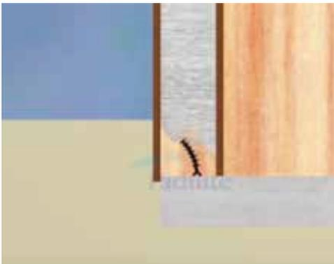
WATER STOP convencional que se necesita termofucionar y muchas veces no se hace bien provocando el paso de agua.
