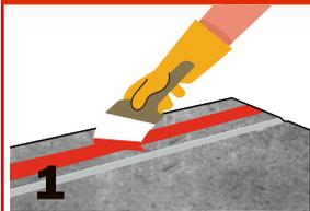
1 Aplicación del Primer AE BENTOBAR para la perfecta adherencia del producto. Previa limpieza de la superficie.
