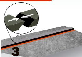
3 Elimine la capa protectora de la cara expuesta del AE BENTOBAR y empalme los finales para formar un sello continuo, ininterrumpido (Para mejores resultados corte cada final a 45°). No superponga los finales de rollo.
