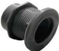
El obturador cumple 2 funciones, la primera consiste en servir como guia para que atravesase la barra roscada y alinea los encofrados conjuntamente con el tubo de PVC. La segunda función es de crear un sello en ambas caras del encofrado para que no se derrame el concreto fresco durante el colado y vibrado sin necesidad de resane, su diseño externo cuenta con extrillas las cual nos garantiza que no pasara agua por la parte exterior de este elemento y quede firmemente atrapado al concreto.
